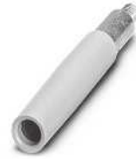
Гнездо под контрольный штекер, 4 мм, для разделительных клемм измерительных преобразователей SRTK 6 и URTK 6, резьба M3
