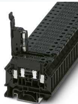
4 (6) мм 2 , 6,3 А, рычажная клемма с держателем предохранителя, для стеклянных предохранителей 5 x 20 мм
