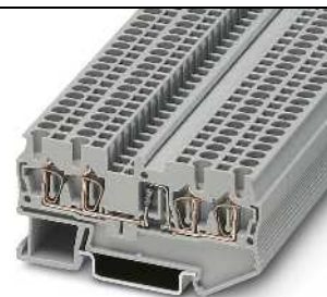
1,5 А, диодная клемма, 1N 5408 (1000 В/1,5 А), 4 разъема
