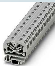
30 А, проходной блок зажимов, боковой кабельный ввод, 4 разъема
