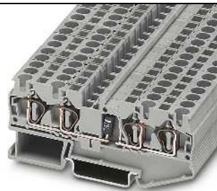
1,5 А, диодная клемма, 1N 5408 (1000 В/1,5 А), 4 разъема
