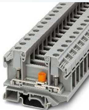
6 (6) мм 2 , 36 А, разделительная клемма для измерительного преобразователя, с винтами контрольных гнезд
