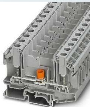
6 (6) мм 2 , 41 А, разделительная клемма для измерительного преобразователя, с винтами для контрольных гнезд, для установки коммутационных перемычек
