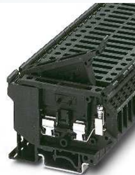
4 (4) мм 2 , 6,3 А, клемма рычажного предохранителя для стеклянных предохранителей 5 x 20 мм
