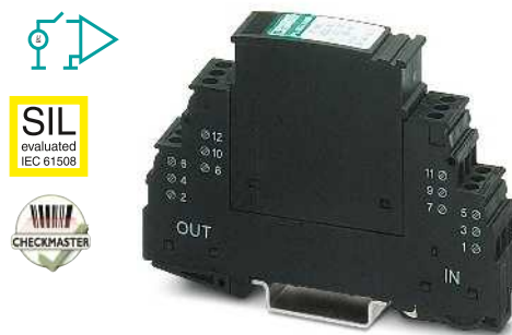
4 проводника, с общим опорным потенциалом, подключение 9/10, заземление через газоразрядник, например, для двоичных сигналов
