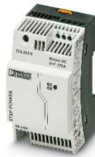
Источник питания, 1-фазный, 24 В DC, 1,75 А NEC, класс 2
