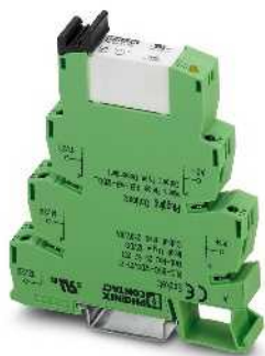
Релейный модуль с 2 переключающими контактами, макс. 2 x 50 мА
