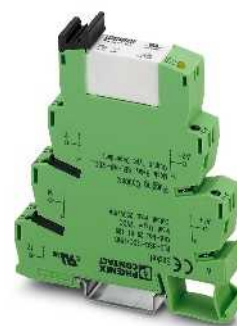
Релейный модуль с 1 переключающим контактом, макс. 10 А
